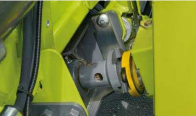
Acoplador de liberação rápida
