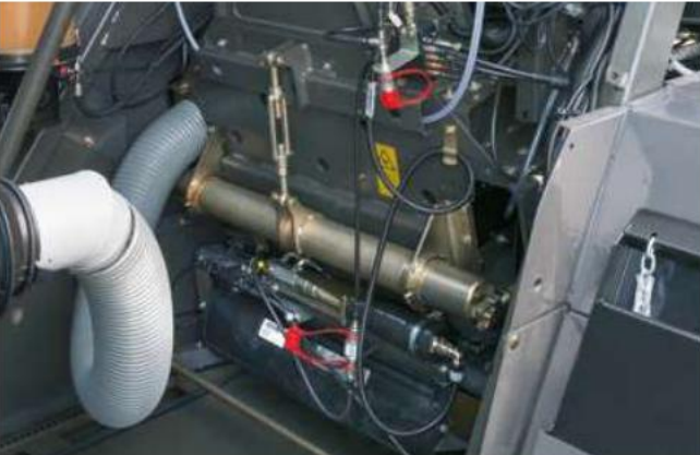
Ajuste mecânico da folga do acelerador de colheita
