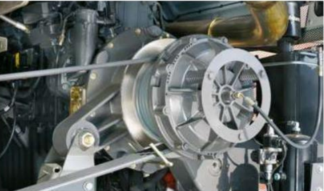
Freio de fluxo de colheita QUICK STOP
